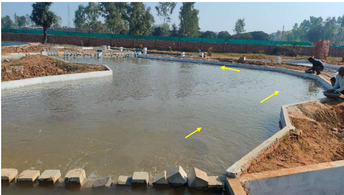
Fig. 7.8 (d) Flow conditions for 105600 m 3 /s discharge
